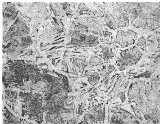
شکل ۲-۱۵ تصویر میکروسکوپی فریت پرویوتکتوئید در قالب صفحات ویدمن اشتاتن در فولاد ۰.۴٪C، Fe. محلول حکاکی نایتال، بزرگنمایی \times 200 [۱].
